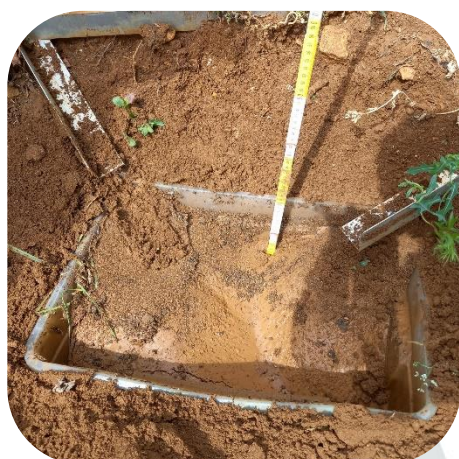
Campionatori per misurare il deflusso delle acque di scorrimento superficiale
