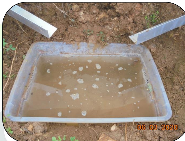
Campionatori per misurare il deflusso delle acque di scorrimento superficiale
